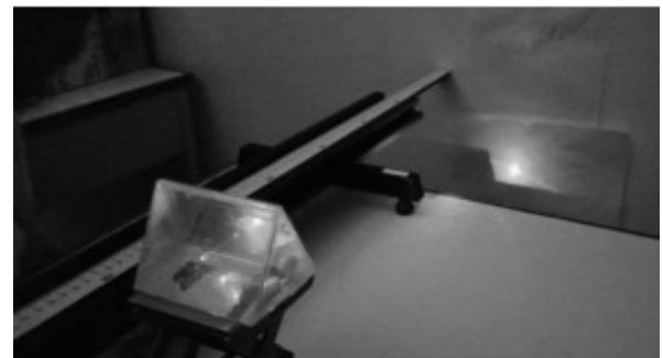
Gambar 2. Proses pengukuran indeks bias air menggunakan prisma berongga
